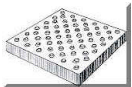
Dalle à protubérances en quinconce (source : http://users.skynet.be/lalumiere/CBPAM/cha pitre5.htm )
